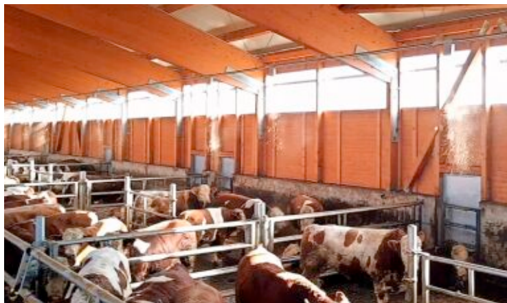
Die Einstreuanlage im Praxiseinsatz: Sie verteilt über den gesamten Tag etwa sechsmal Einstreu. Rechts ist der Einstreubunker mit Rohrkettenförderer zu sehen.
